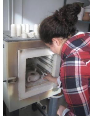
Fotoğraf 14: Sırlanmış ürünün seramik fırınına yerleştirilmesi
